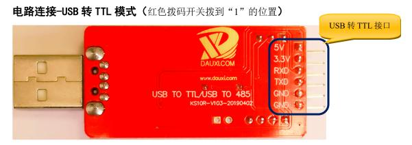
如上图所示,将 KS10R 拔出电脑。KS10R 上有 6 针引脚 OUT1,每个引脚依次为: 5V,3.3V, RXD, TXD, GND, GND。与 KS10X 相连时的,KS10R 的 5V 或 3.3V 接 KS10X 的 VCC; KS10R 的 RXD 接 KS10X 的 SDA/TX; KS10R 的 TXD 接 KS10X 的 SDA/TX; KS10R 的 GND 接 KS10X 的 GND;如果 KS10X 有 MODE 脚,则 KS10R 的另一 GND 接 KS10X 的 MODE;连接图如下:
