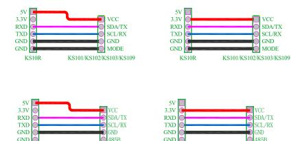
电路连接-USB 转 485 模式 (红色拨码开关拨到 "ON"的位置)
