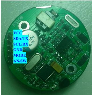
在 KS109 上连线引脚上标识有: VCC、SDA/TX(简称 SDA)、SCL/RX(简称 SCL)、GND、MODE 及 AN/SW。MODE 引脚悬空时, KS109 工作于 I<sup>2</sup>C 模式。
