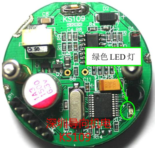
KS109 启动后如果收到主机的有效数据指令, LED 将立即停止闪烁显示。进入指令探测模式。
