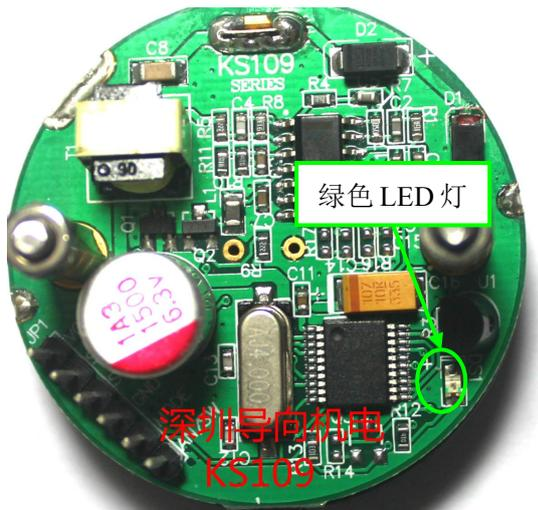
KS109 启动后如果收到主机的有效数据指令，LED 将立即停止闪烁显示。进入指令探测模式。每探测一次 LED 灯会闪烁一次。
