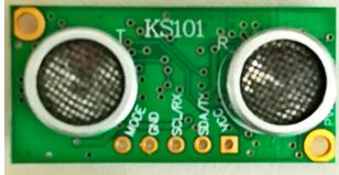
其中 VCC 用于连接+5V(3.0~5.5V 范围均可)电源<sup>(1)</sup>, GND 用于连接电源地, SDA/TX 是 I<sup>2</sup>C 通信的数据线, SCL/RX 引脚是 I<sup>2</sup>C 通信的时钟线。SCL 及 SDA 线均需要由主机接一个 4.7K(阻值 1~10K 均可)电阻到 VCC。KS101 的 I<sup>2</sup>C 通信速率建议不要高于 100kbit/s。
